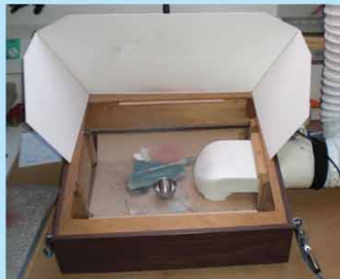
Afbeelding 2: De afzuiging is naar beneden gericht.
